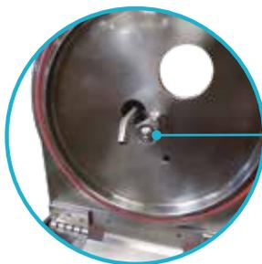
**Kuchenspülrohr** mit einer oder mehreren Düsen.
